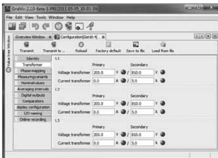
Obr. Konfigurace transformátorů proudu a napětí pomocí software GridVis.
