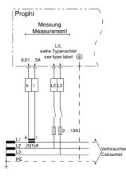
Abb.: Anschluss der Mess- und Hilfsspannung zwischen L2-L3 und der Strommessung über Stromwandlers.
